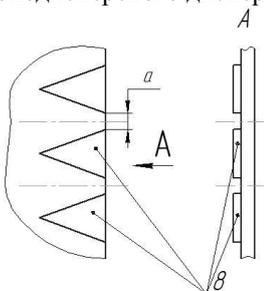
Рисунок 2 - Фрагмент кромки лопастей с клиновидными обтекателями
