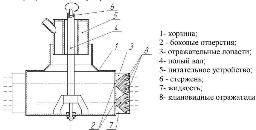
Рисунок 1 - Устройство для монодисперсного диспергирования жидкостей и плавов
